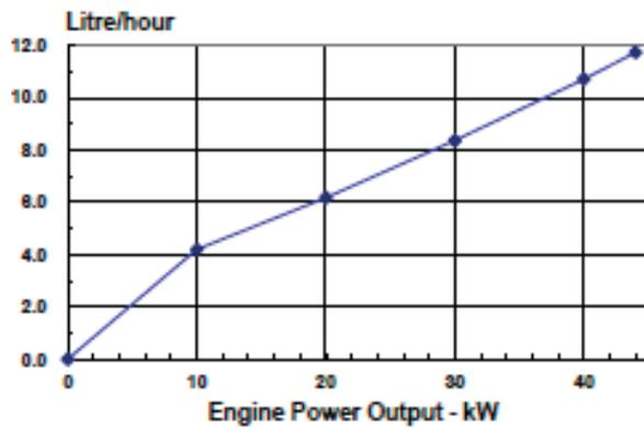
Las curvas mostradas anteriormente representan las capacidades de rendimiento de los motores en bruto, obtenidos y corregidos en acuerdo con GB/T18297 en condiciones de 100 kPa (29,61 in. Hg), presión barométrica [80 m (263 ft.) altitud], 25 °C (77 °F) entrada de la temperatura del aire y 1 kPa (0,30 in. Hg) presión de vapor de agua con No. 0 combustible diesel.
