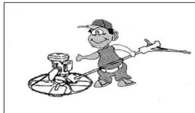
7. Permita que el motor caliente por unos 3-5 minutos antes de poner a la máquina bajo carga.
