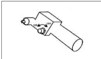
5. Coloque el acelerador en posición media.
